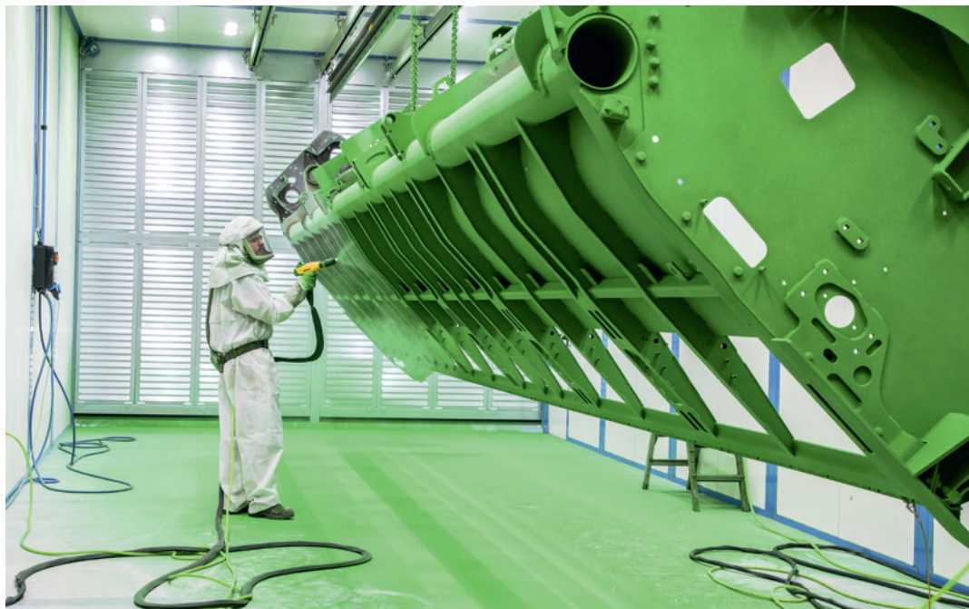
Die Pulverapplikation erfolgt manuell. Dafür stehen den Beschichtern zwei Pulvergeräte zur Verfügung. Die Werkstücke können in jedem RAL-Ton und weiteren Sonderfarben beschichtet werden.
